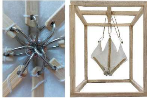
Şekil 15. (Sol) Kare tabanlı fiziksel model 2 birleşim detayı. (Sağ) Katlanabilir kalıp modelin ahşap çerçeveye asılması.
