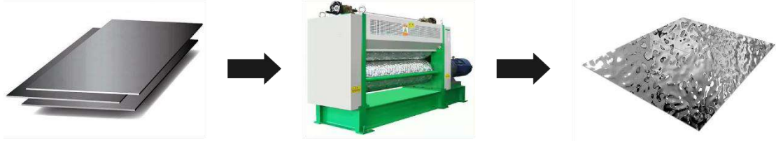
Şekil 1. Kabartma makinesi ile desen üretimi.
