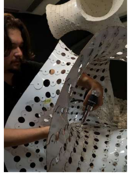
Şekil 9. Şeritlerin perçin tabancasıyla montajının tamamlanması
