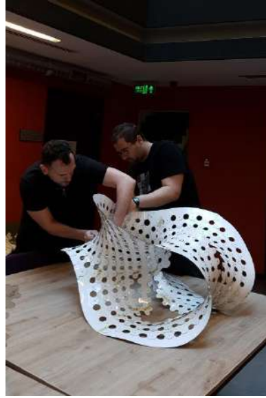
Şekil 8. Formun üzerinde çalışılması için geçici civatalarla tutturulması
