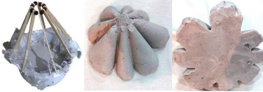
Şekil 18. (Sol) Daire tabanlı katlanabilir kalıba beton dökümü. (Orta) Üretilen beton blok. (Sağ) Beton blok taban yüzeyi.
